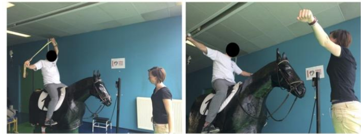
Şekil 2. Mekanik Hipoterapi Simulatorü (Bailet vd., 2019).
